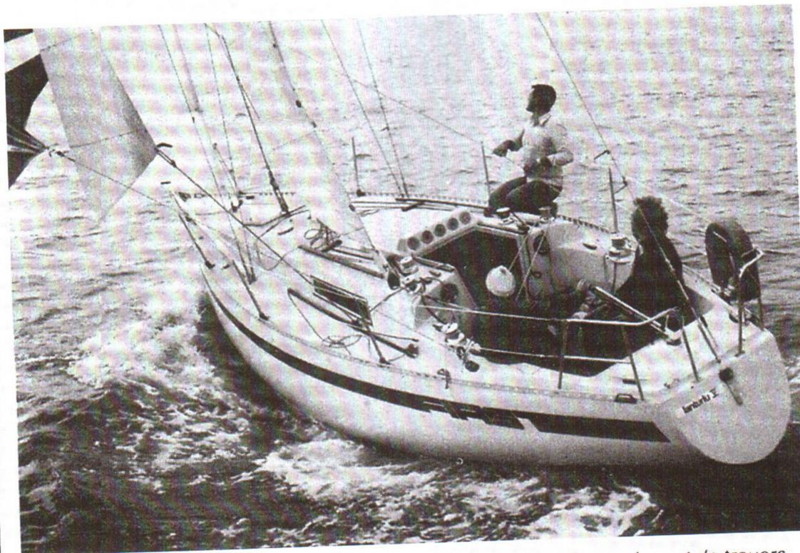
Au portant, la trinquette augmente la vitesse d'environ 1/2 nœud, vent de travers.
